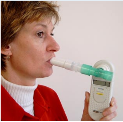
Abb. 1 ▲ Messung des H 2 -Gehalts in der Ausatemluft (Foto: Fischer Analysen Instrumente GmbH)
